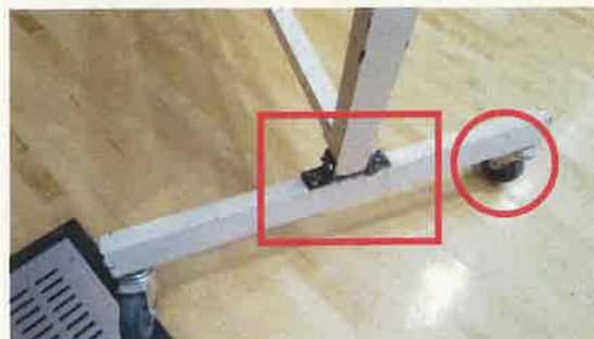
▲修理 (□部分), 交換 (○部分)
