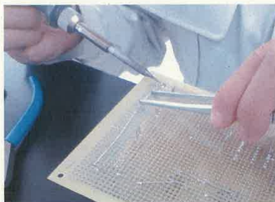
はんだ付けの様子
