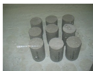
ひび割れ防止に水中養生(20℃に設定)
