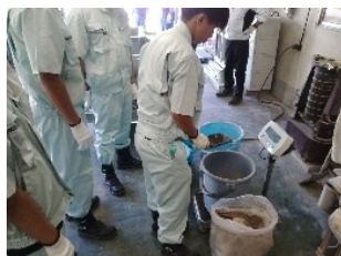
水、セメント、細・粗骨材の計量
