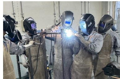
実習中では行わない低い位置での溶接と高い位置での溶接の様子。
